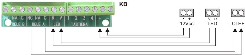
Fonctionnement **MONOSTABLE** avec centrales d'automatisation
