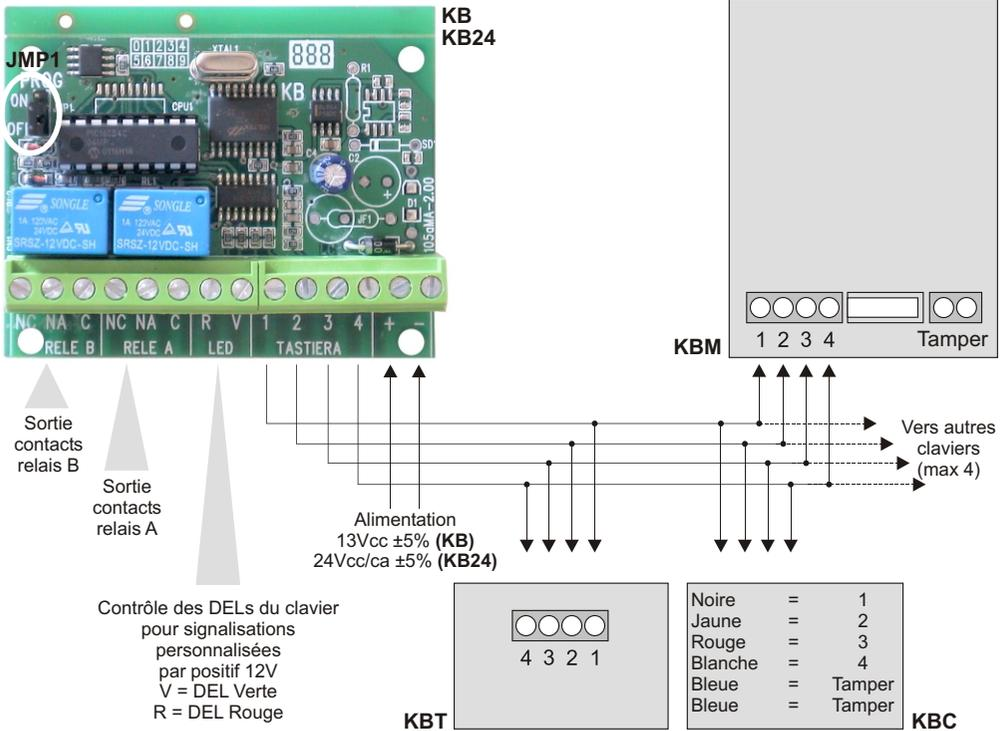
KB24 est un système de commande à clavier électronique en mesure de piloter deux sorties relais au moyen de deux codes personnalisables indépendamment ou en combinaison. Il peut être utilisé pour brancher et débrancher des systèmes d'alarme, pour le contrôle d'accès et pour toutes applications demandant une commande fiable, sûre et simple à installer et utiliser.
