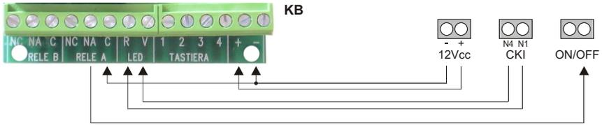
Fonctionnement **BISTABLE** (pas à pas) avec TM300/TM400/TM500/TM900
