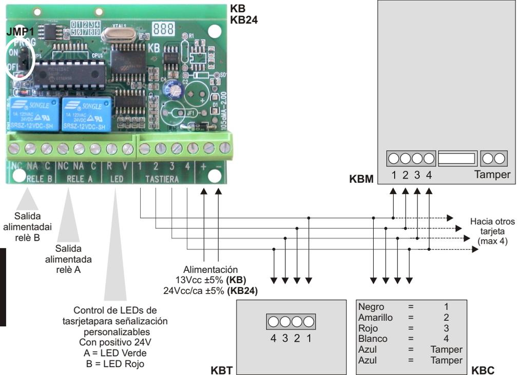
El KB24 es un sistema de comando con un teclado electrónico capaz de pilotar dos salidas relé mediante dos códigos personalizables de manera independiente o combinada. Se puede emplear para introducir y retirar instalaciones de alarma, para controlar accesos y para cualquier aplicación que precise un mando fiable, seguro y de sencilla instalación y utilización.
